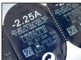
Bei der Mehrzahl der bereits beschriebenen pharmazeutischen Standardanwendungen bieten bereits ein herkömmlicher 30 Watt-CO<sub>2</sub>-Laser oder ein 20 Watt-Faserlaser ähnlich hohe Liniengeschwindigkeiten wie die TIJ-Technologie. Bei anspruchsvolleren Trägermaterialien (z. B. Kunststoffen, Folien, Metallen) kann es jedoch zu längeren Markierzeiten und niedrigeren Liniengeschwindigkeiten kommen. Doch diese
