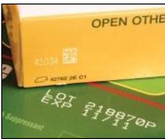
Beim Abtragprozess für Lasermarkierungen entsteht Qualm, der kleine Partikel und Gase enthält, die gesundheitsschädlich sein können. Das Lasern von Kartons aus Graupappe und Papieretiketten führt ebenfalls zur Bildung von Partikeln, die von den Bedienern der Linie eingeatmet werden könnten. Die beste Vorgehensweise bei der Installation einer Lasertechnologie ist stets die Einrichtung eines Absaug- mit einem Filtersystem. In der Regel kommen drei Filterarten
